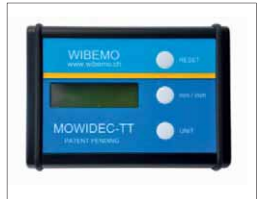
On ne peut plus simple, l'écran indique l'erreur au diamètre en micron et par une simple correction des offsets, celle-ci est compensée. Recentrer des broches devient un jeu d'enfant!
