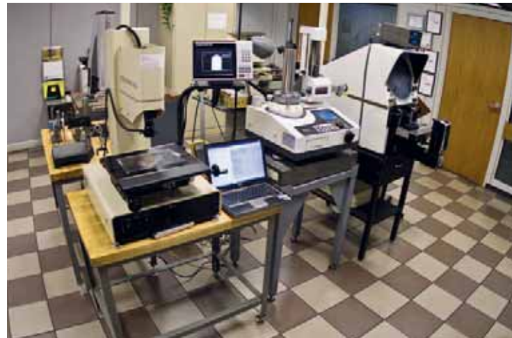
Le département de contrôle qualité de DuAll s'appuie désormais sur un équipement de mesure optique rapide, un élément devenu indispensable face à la productivité élevée et à la précision extrême des pièces réalisées par les machines Tornos de DuAll.
